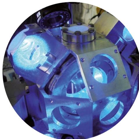
*Horloge optique à atomes de strontium refroidis et piégés par laser du SYRTE
