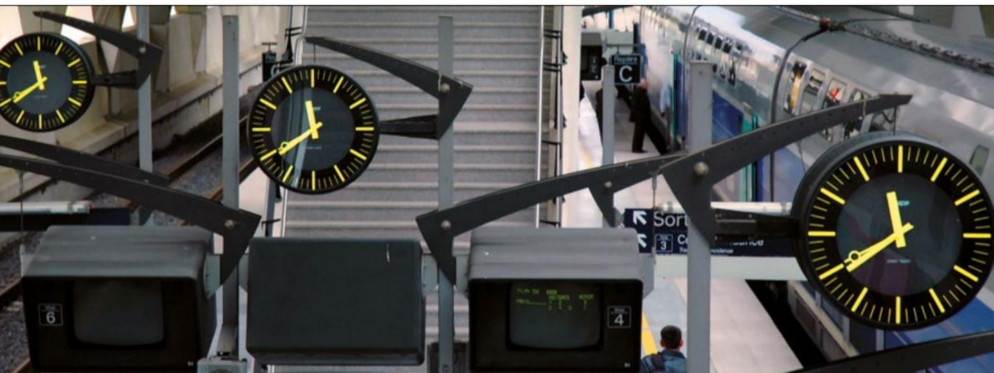
En 1993, GORGY TIMING conçoit et fabrique la première horloge analogique au design TGV élaborée avec les architectes de la SNCF. Elles sont pilotées par le code AFNOR NFS 87500 avec une remise à l'heure permanente.
