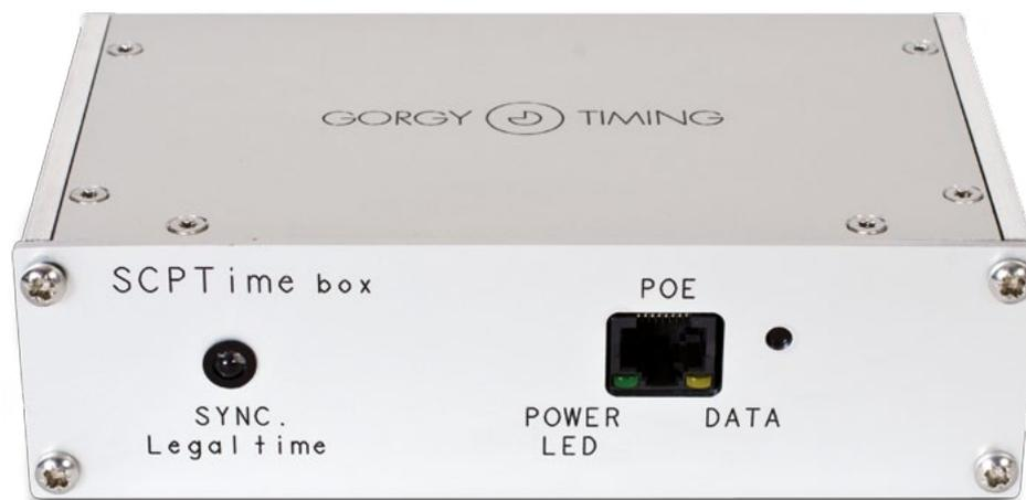
Le développement de la BOX NTP BiaTime® a pour objectif de diffuser un message horaire certifié et traçable provenant de l'heure légale d'un pays (en France, le SYRTE de l'Observatoire de Paris) jusqu'à l'utilisateur final avec une précision à la milliseconde quelle que soit la distance.
